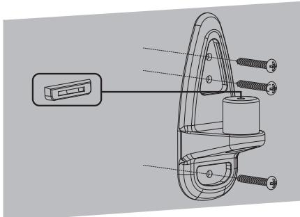
Markieren Sie die Stelle für die Montage mit einem Bleistift. Stellen Sie sicher, dass die Wandstruktur das Gewicht des Monitors zusammen mit dem Halter trägt. Nur an den Holzständern einer Gipskarton- oder Hohlwand montieren!
