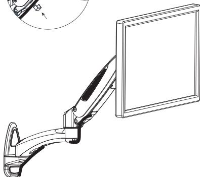
Führen Sie die Kabel in die Kabelabdeckungen ein. Lassen Sie den Kabeln, für eine optimale Einstellung, genügend Spielraum an den Gelenken.
