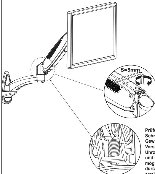
HINWEIS: Drehen Sie im Uhrzeigersinn, um die Spannung bei leichteren Monitoren zu verringern, und gegen den Uhrzeigersinn, um die Spannung bei schwereren Monitoren zu erhöhen.
