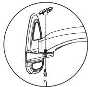
Führen Sie die Schraube durch die Bohrung der Wandplatte in Richtung der Abdeckkappe.
