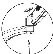
Führen Sie die Schraube durch die Bohrung des Verlängerungsarms in Richtung der Abdeckkappe.
