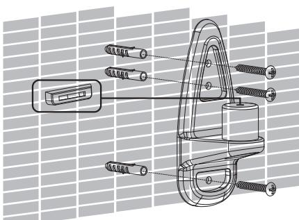
Markieren Sie die Stelle für die Montage mit einem Bleistift. Stellen Sie sicher, dass die Wandstruktur das Gewicht des Monitors zusammen mit dem Halter trägt. Achten Sie auf Strom- und Wasserleitungen!
